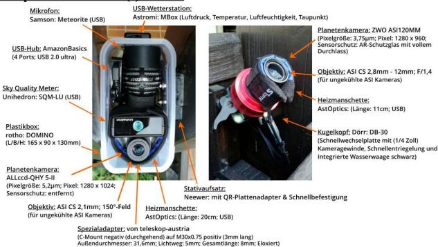
Die Meteo(r)-Station besteht aus 2 Hauptkomponenten, welche zusammen, als auch separat verwendet werden können. Die Meteor-Videokamera mit lichtstarkem Weitwinkelobjektiv übernimmt die Videoüberwachung des Nachthimmels auf der Suche nach Meteoren.
