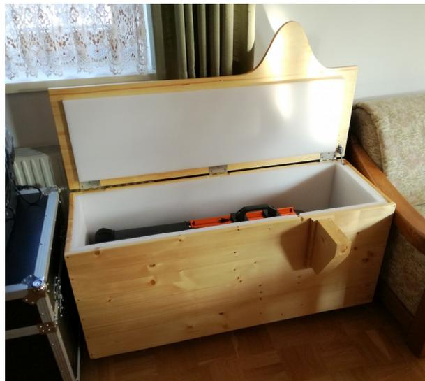
Der Innenraum der Box ist sowohl für den Aufbau zur Sonnensystem-Fotografie (bestehend aus C11 inkl. Okularauszug), als auch für den Aufbau zur Deepsky-Fotografie (bestehend aus C11 inkl. Hyperstaraufsatz mit adaptierter DSLR-Kamera und Hauptspiegel-Microfocuser) konzipiert. Taukappe und Filterrad mit Planetenkamera finden ebenfalls Platz. Das Stativ ist am Deckel der Box auf aufgeklebten Filzmatten abgestellt.
