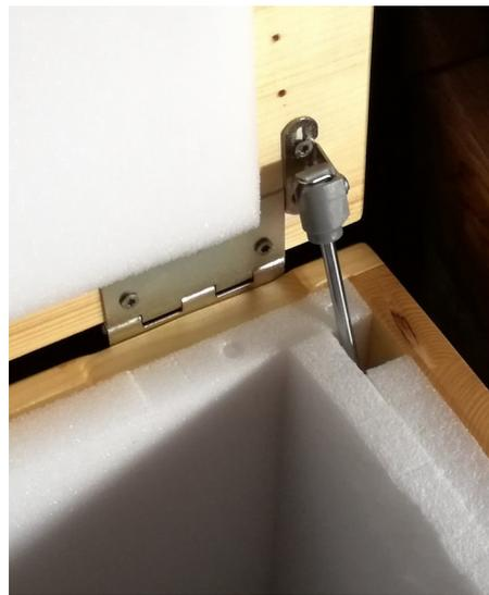
Der an der vorderen Seitenwand angebrachte Sockel stützt den Deckel ab, damit dieser die Last des Stativbeins trägt.
